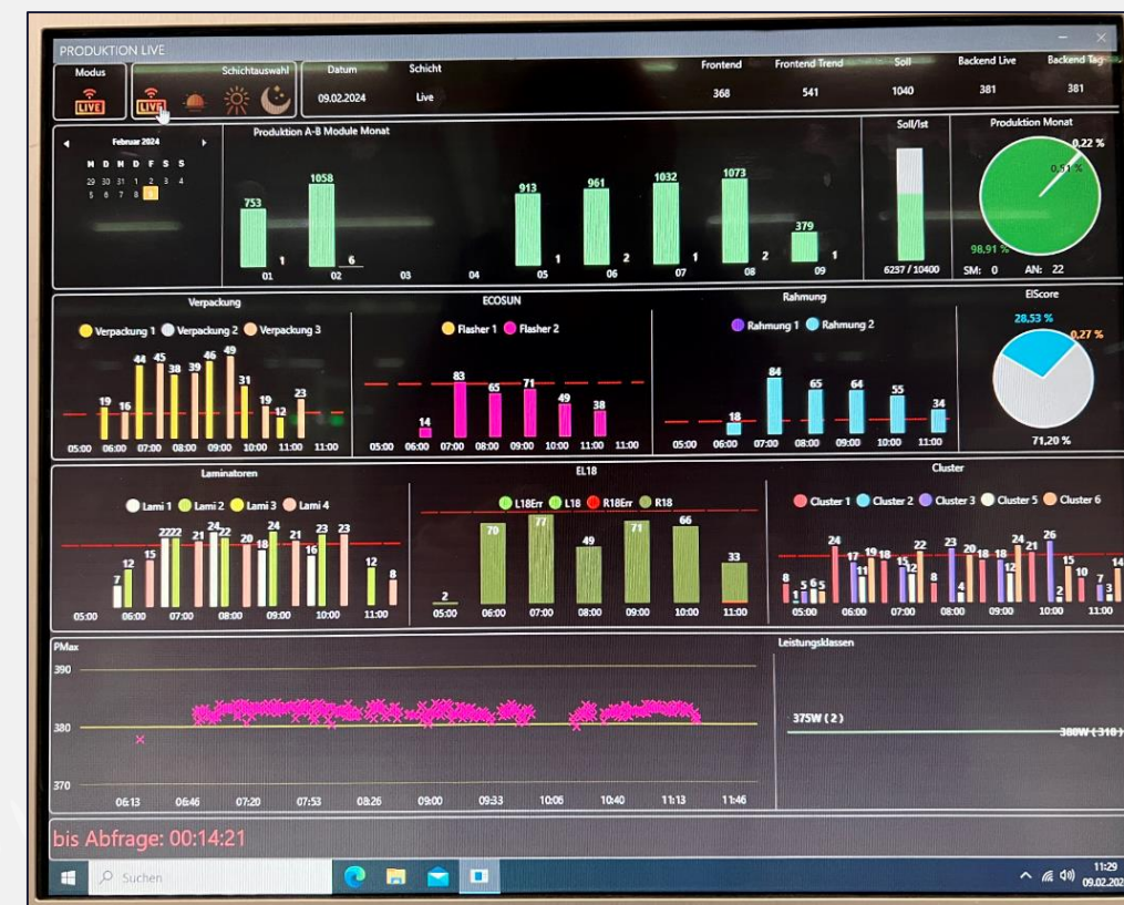
Abb.: MES –System Fertigung Heckert Solar, Werk Langenwetzendorf
